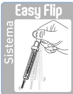
Con il supporto Easy Flip potete facilmente azzerare la misurazione del vostro termometro:
